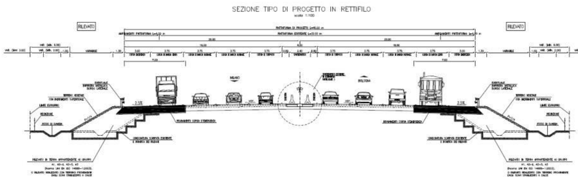
Figura 14.1.1 - Sezione tipo di progetto in rettifilo con ampliamento simmetrico.
