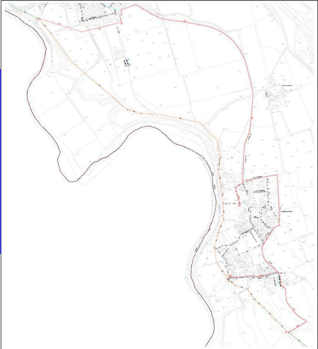
Figura 12.3.3 - Planimetria dello studio di massima dello spostamento del collettore intercomunale di recapito al depuratore di Salerano sul Lambro; in verde è rappresentato il collettore esistente, in arancione il collettore esistente da spostare, in rosso il collettore di progetto.
